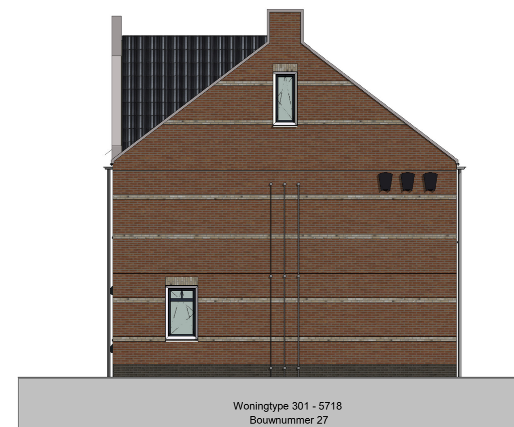
Rechtergevel Nestkasten en spandraden zijn indicatief ingetekend
